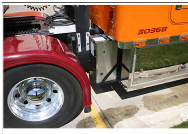
Рис. 7 - Бортовой генератор водорода (небольшая коробка справа от колеса)
