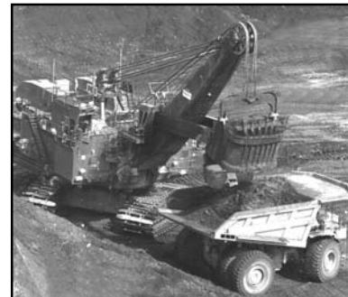
*Рис. 2. Канада. Видобуток нафтонасичених пісків відкритим способом (провінція Альберта)*
