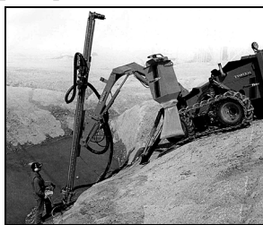
Бурильна установка "ТАМРОК КОММАНДО — 300" при проведенні виробок розкриття у горах.
