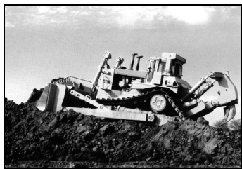
Булдозер D11N фірми Катерпіллер (США) — один з найпотужніших в кінці ХХ ст.
