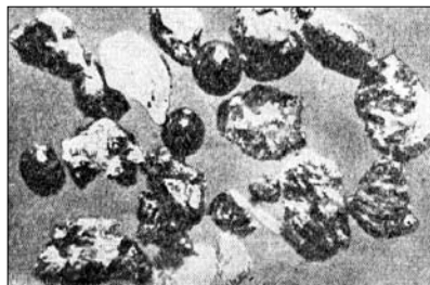
Реголіт. Проба взята на Місяці станцією "Луна-16". Розмір зерен 0,25 – 0,5 мм.
