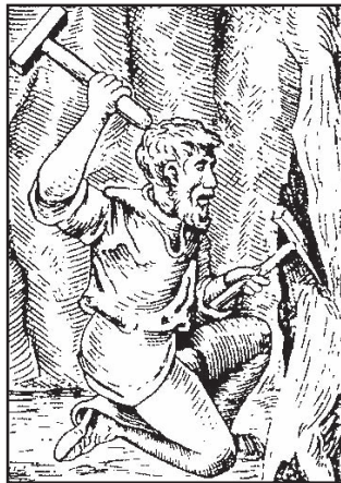
Руйнування порід за допомогою гірничих молотків
